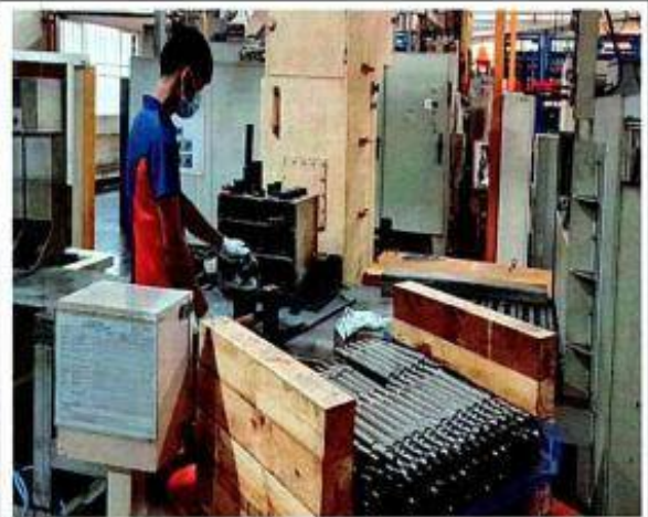
Lắp trục rotor vào lõi rotor
